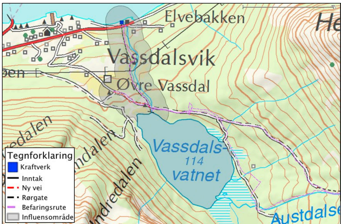
Figur 2. Kart over de viktigste installasjoner i forbindelse med tiltaket. Influensområdet (skravert) i henhold til tommelfingerregelen om at en sone på ca 100 meter langs berørte elvestrekninger og fysiske inngrep blir berørt.
